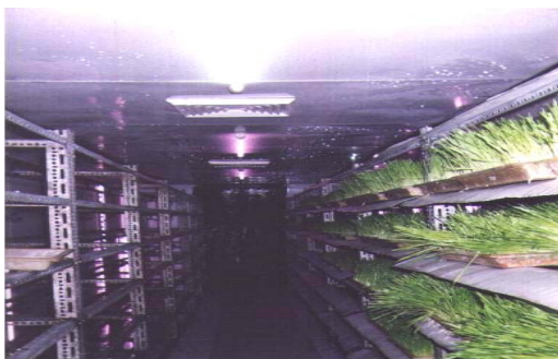
Fotografía N° 21: Detalles Internos de una "Fábrica de Forraje". Obsérvese la fuente de iluminación, el diseño de los módulos y el sistema de acondicionamiento del aire interior ubicado en el
